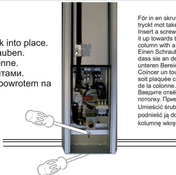
För in en skruvmejsel under pelaren så att den ligger tryckt mot taket. Skruva sedan fast pelaren nedtill.
