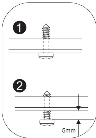
Skruva först in de båda skruvarna så att de bottnar. Skruva sedan ut dem 5 mm.
