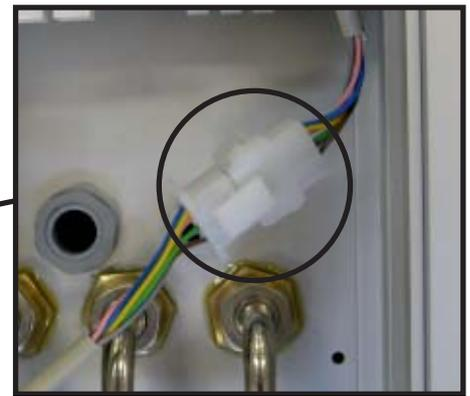
Koppla loss elkopplingen och de fem snabbkopplingarna för vatten, (2xblå, röd, grön och svart). Lägg sedan locket åt sidan.
