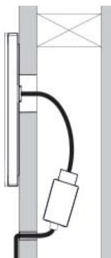
Wenn die Steuerung ohne Halterung befestigt werden soll, das Kabel jedoch außen an der Wand verlaufen muss, kann eine Lösung wie die folgende verwendet werden, siehe Bild. Beachten Sie, dass das Loch in der Wand, durch das die Buchse geführt werden soll, mindestens 30 mm groß sein muss.
