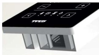
Fäst konsolen så lågt som möjligt på manöverpanelen. Montera upp panelen på väggen. Använd medföljande manöverpanelsledning för att ansluta manöverpanelen till bastuaggregatet. Är manöverpanelsledningen för lång går den att klippa av till lämplig längd och använda medföljande extrakontakt. OBS det krävs specialtång för detta (crimptång för RJ10).
