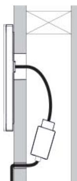
Jeżeli panel sterowania ma zostać zamontowany bez wspornika, z kablem ułożonym na wierzchu ściany, można zastosować poniższe rozwiązanie (patrz rysunek). Należy pamiętać, że otwór w ścianie do przeprowadzenia wtyczki musi mieć średnicę co najmniej 30 mm.
